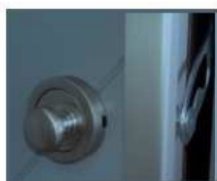
1. Controlador apertura Accionando desde el interior permite una apertura limitada de la puerta con garantía de seguridad. Opcional controlador de 2 posiciones (controlador/cerrojo).
