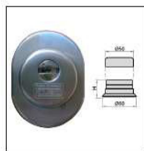
6. Protector de cilindro: Cuerpo de acero carbonitrurado. Dureza Rockwell mínimo 60 Hrc. Con placa templada antiextracción y antitaladro.
